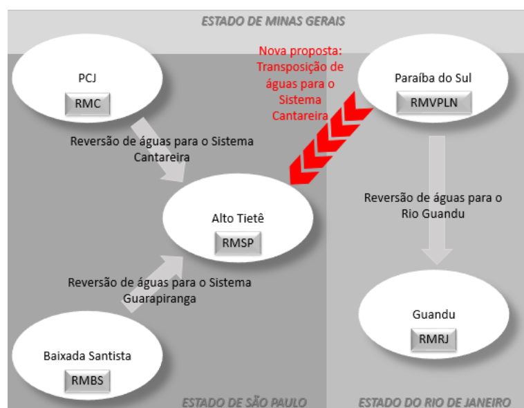
Figura 2. Desenho esquemático da interligação dos sistemas pertencentes à Hidromegalópole: as bacias hidrográficas, as regiões metropolitanas que as compõem, os estados aos quais as bacias pertencem e as ligações entre os sistemas.
